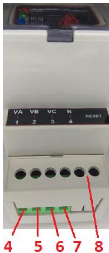
FIGURA 2 – CONEXÕES DE TENSÃO E BOTÃO DE RESET DO MEDIDOR SM-3W.
